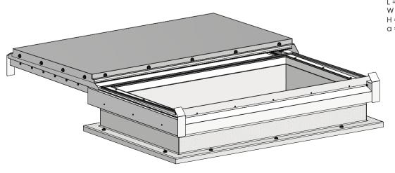
L = LUNGHEZZA APERTURA (MAX 250 cm PER EVACUAZIONE FUMI) W = LARGHEZZA APERTURA (MAX 130 cm PER EVACUAZIONE FUMI) H = ALTEZZA BASAMENTO (MIN 25 cm PER EVACUAZIONE FUMI) a = CIRCA 2 cm DI PENDENZA PER DEFLUSSO ACQUE
